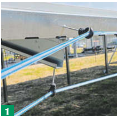
1 Weidezaunlitzten unter Strom garantieren, dass sich nur Kälber unter die niedriger aufgestellten Module stellen können. 2 Schlitzlöffel für die Schraubverbindungen und ein Baukastenprinzip lassen einen sehr individuellen Aufbau zu. 3 Auch Hühner fühlen sich unter Agri-PV sichtlich wohl.
