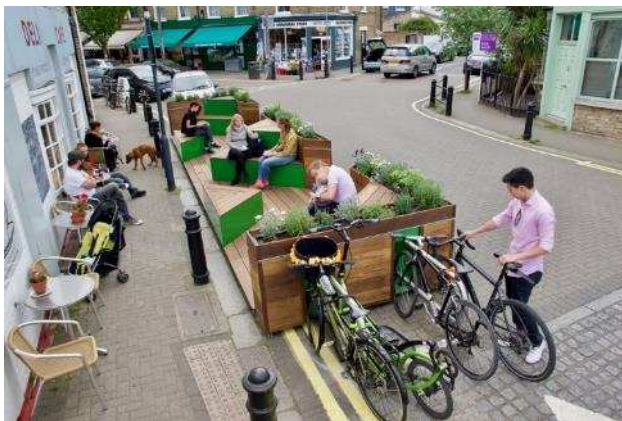
Foto: aufgestellte Parklets mit integrierter Radabstellanlage 27
