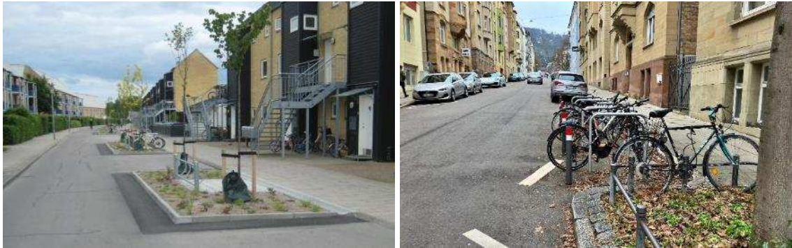
Fotos: mögliche Fahrbahnverengung als verkehrsberuhigende Maßnahme 23
